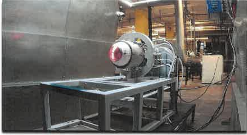
Şekil 12: KJT-3200, -40°C Düşük Sıcaklık Performans Testinden Görünüm
