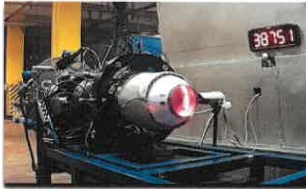
Şekil 11: KTJ-3200 Mukavemet Testlerinden Görünüm
